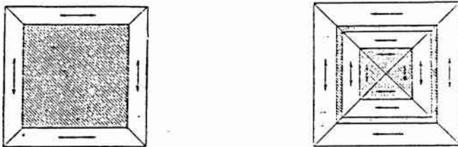
Coupe parallèle à p, d'un cristal cubique, vue entre deux nicols croisés.
